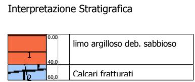
PROVA PENETROMETRICA DINAMICA DPM 3
